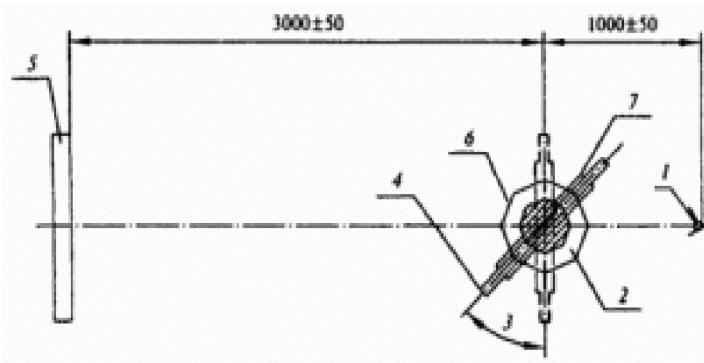
1 - наблюдатель; 2 - лимб; 3 - угол просмотра; 4 - образец; 5 - экран «кирпичная стена»; 6 - поворотный стол; 7 - каретка
